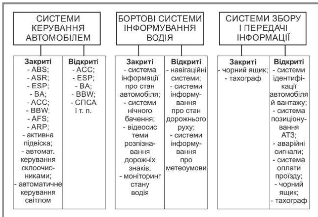
Рис. 7.4. Класифікація бортових систем інтелектуального автомобіля
