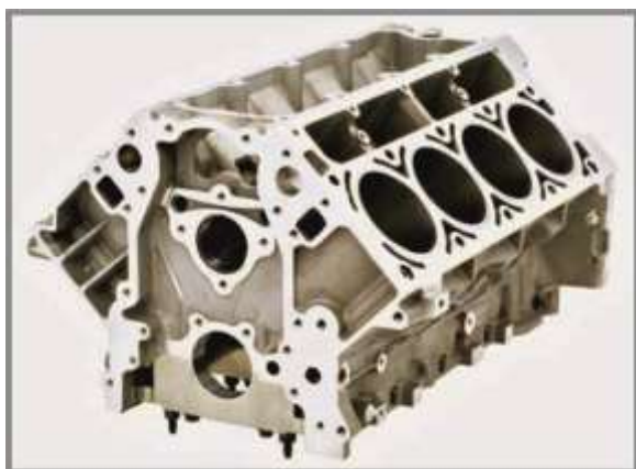
Рис. 2.23. Алюмінієвий блок циліндрів двигуна V8 з запресованими «сухими» гільзами. У нижній частині блоку видно раму сходового типу, за допомогою якої кріпиться колінчастий вал
