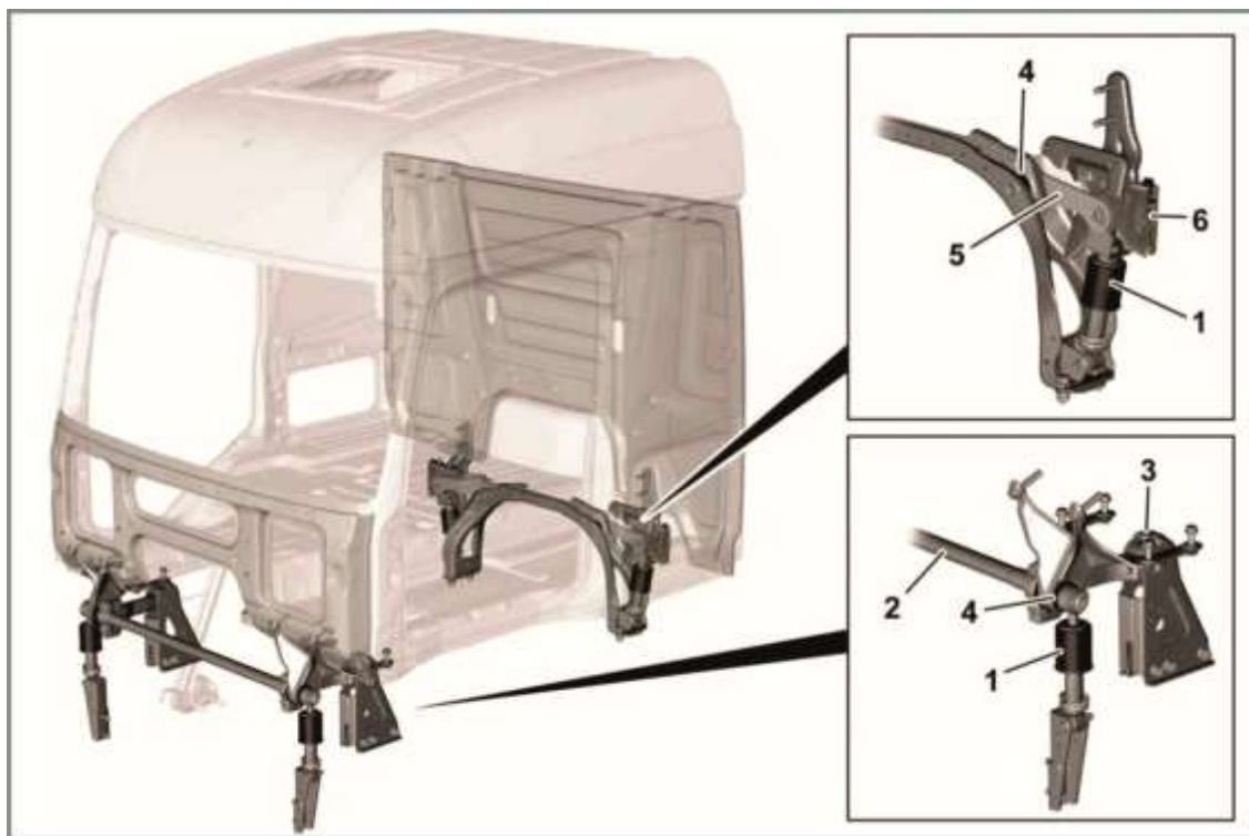
Рис. 5.3. Система підресорювання кабіни вантажного автомобіля Mercedes-Benz Actros (Model 963): 1 – пневмобалони; 2, 3 – стійка та втулка стабілізатора; 4 – гумовий підшипник ковзання; 5 – поперечна ручка управління; 6 – стопор
