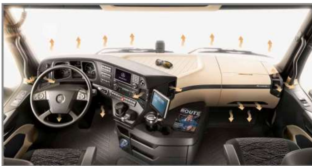
Рис. 6.8. Циркуляція повітря в кабіні автомобіля Mercedes-Benz Actros 2
