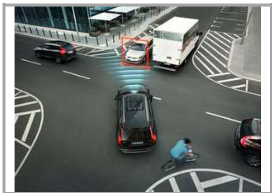
Рис. 7.35. Функція автоматичного гальмування перед зустрічним транспортом
