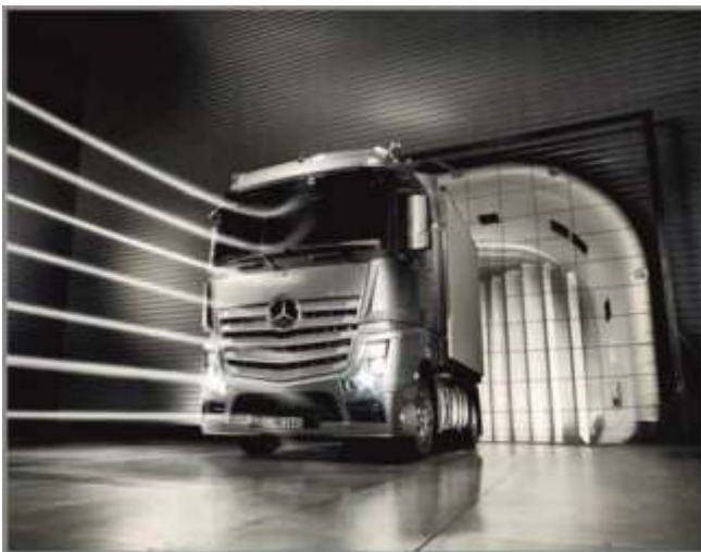
Рис. 5.4. Випробування автомобіля Mercedes-Benz Actros (Model 963) у аеродинамічному тунелі
