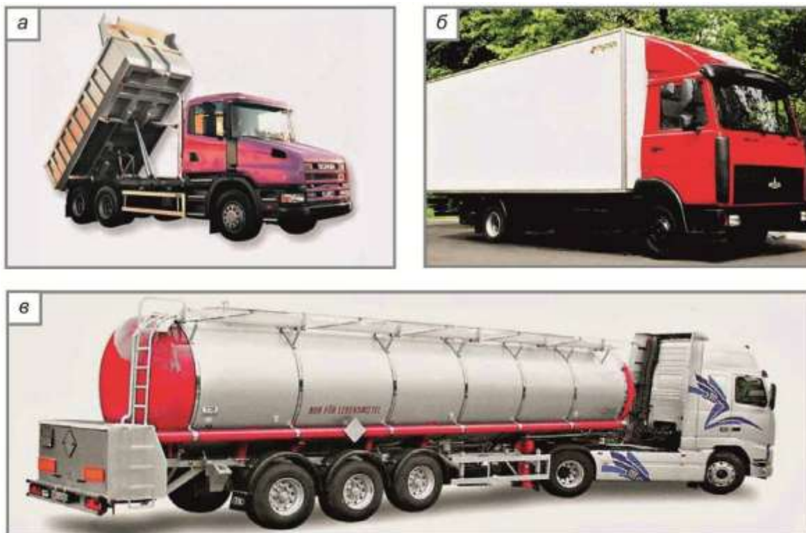
Рис. 1.7. Вантажні автомобілі з різними кузовами: а – самоскид; б – фургон; в – в складі сідельного тягача і автоцистерни-напівпричепа
