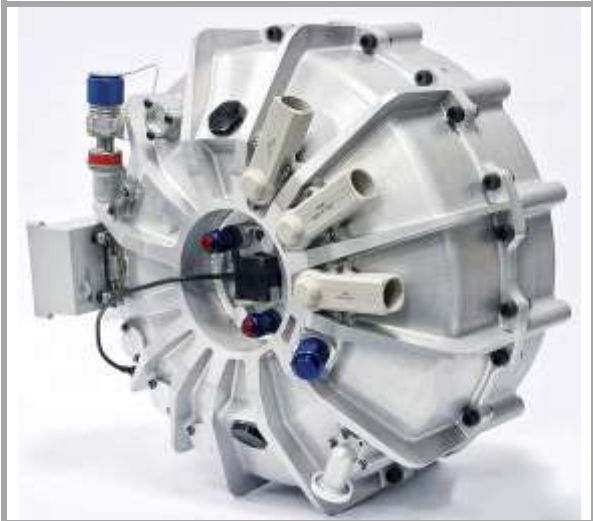
Рис. 8.4. Маховик від Williams Hybrid Power, що застосовуються на автобусах Лондона як допоміжний привод
