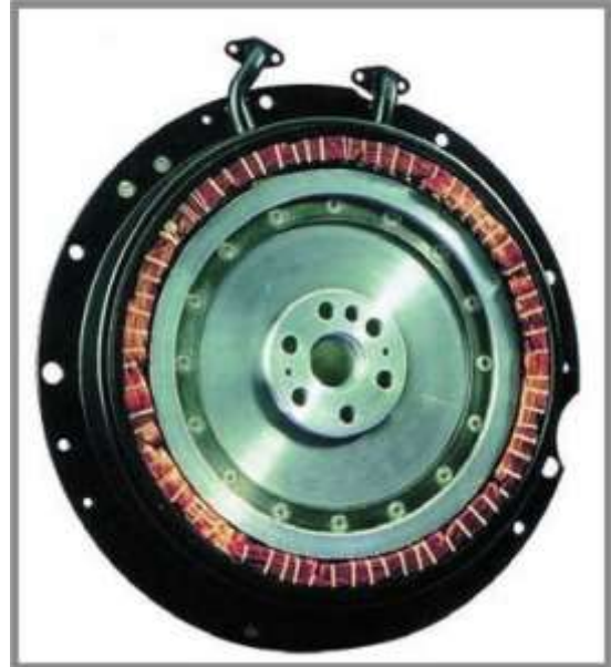
Рис. 2.101. Стартер-генератор на маховику двигуна
