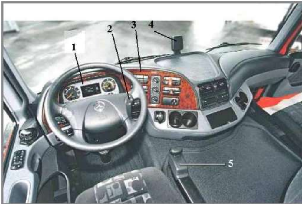
Рис. 6.1. Органи керування автомобілем Mercedes-Benz Actros: 1 – інструментальна панель приладів з багатофункціональним дисплеєм; 2 – багатофункціональне рульове колесо; 3 – панель перемикачів; 4 – радар; 5 – джойстик керування коробкою передач
