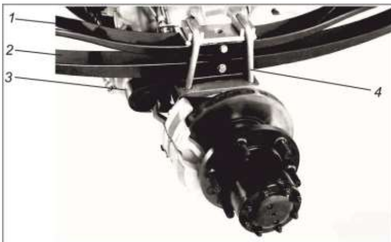
Рис. 5.10. Однолистова ресора заднього моста вантажного автомобіля Concept Cargo фірми Ford:
