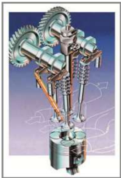
Рис. 2.18. Чотирьохклапанна камера згорання. Застосування газорозподільного механізму з чотирма клапанами на циліндр в дизельному двигуні
