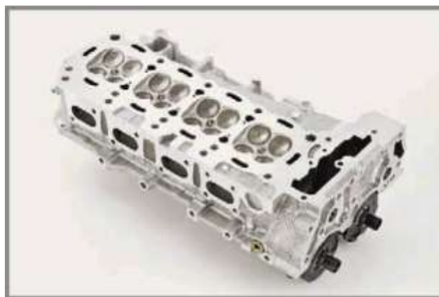
Рис. 2.24. Головка блоку чотирициліндрового рядного двигуна з двома розподільними валами і чотирма клапанами на циліндр
