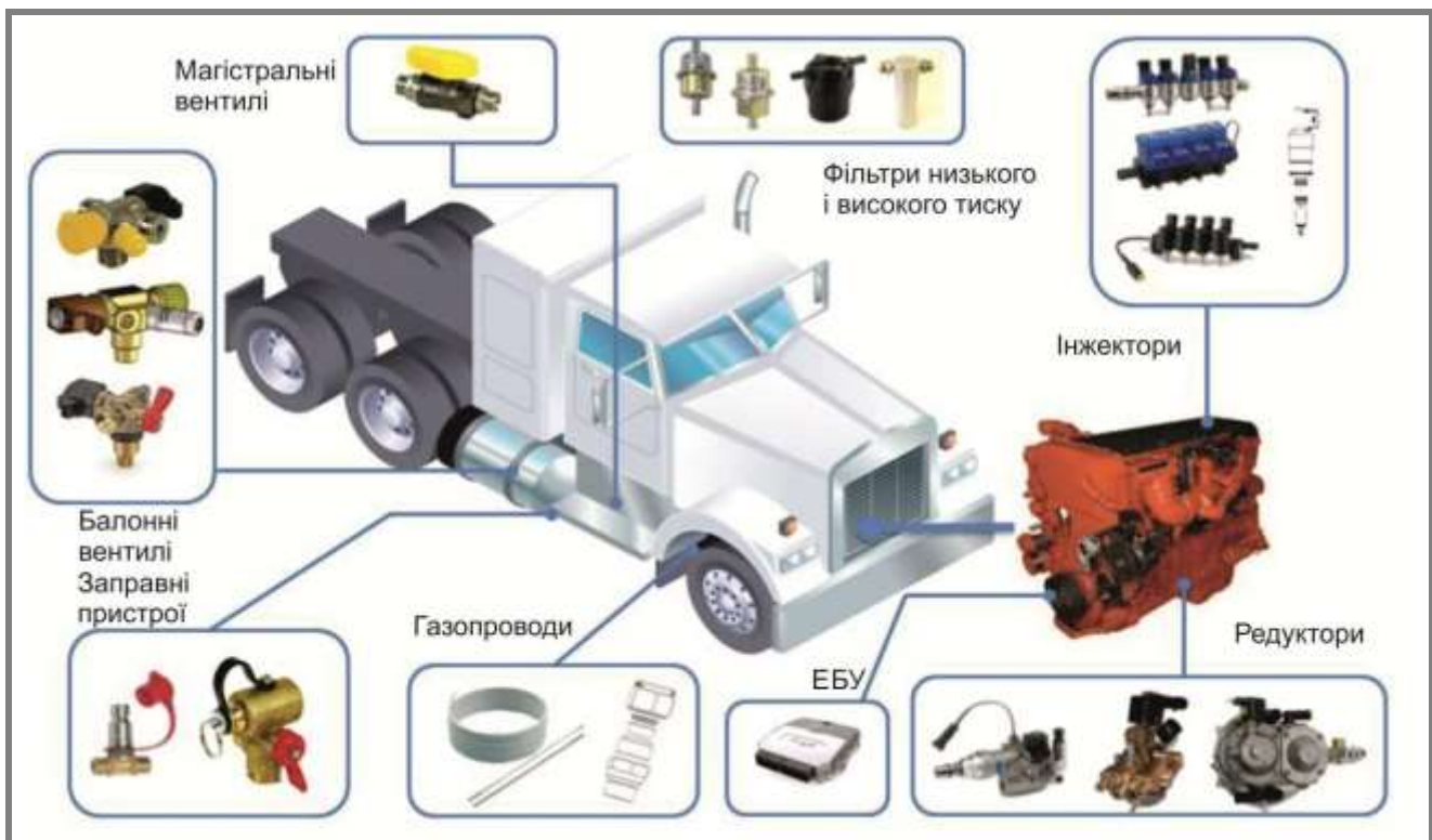
Рис. 2.80. Комплектація вантажного автомобіля додатковим обладнанням при переводі двигуна на газовий цикл роботи
