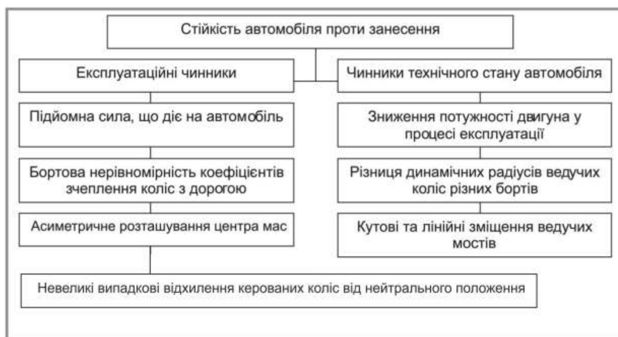
Рис. 7.15. Експлуатаційні чинники та чинники технічного стану, які забезпечують стійкість автомобіля проти занесення
