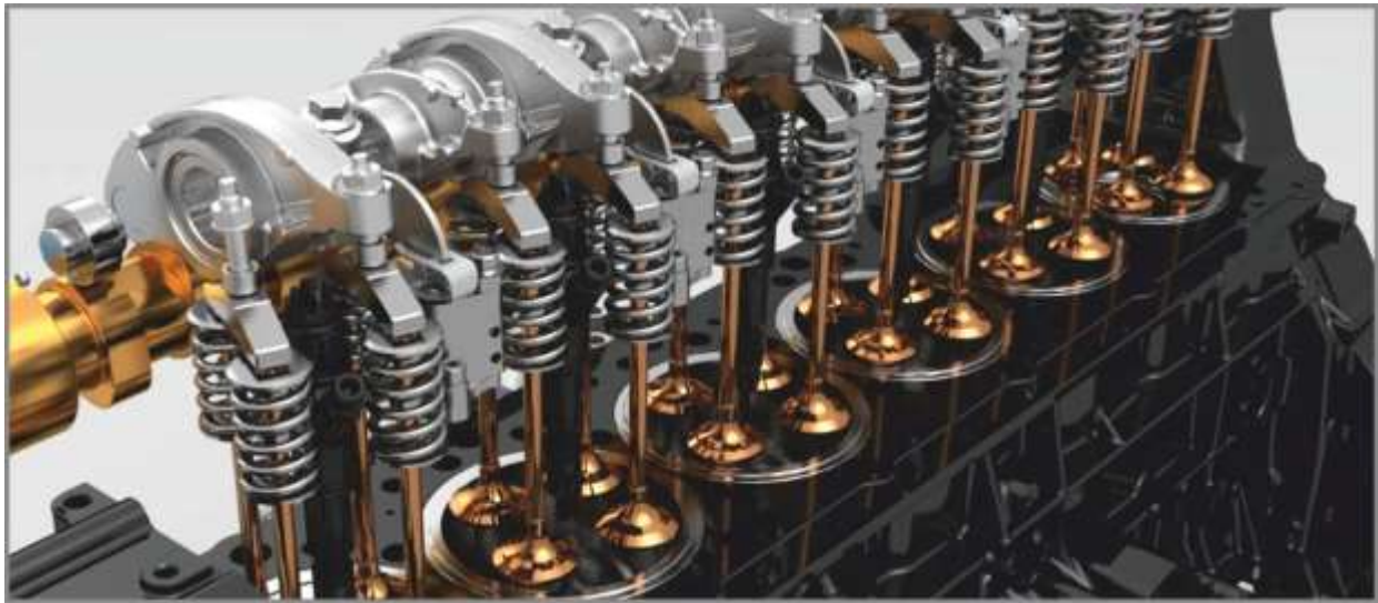
Рис. 2.17. Загальний вигляд механізму газорозподілу двигуна FPT Cursor 13 з розміщенням розподільного вала в головці циліндрів
