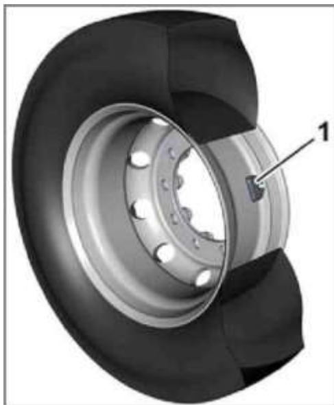
Рис. 5.27. Розміщення датчику 1 тиску повітря у шині на ободі колеса
