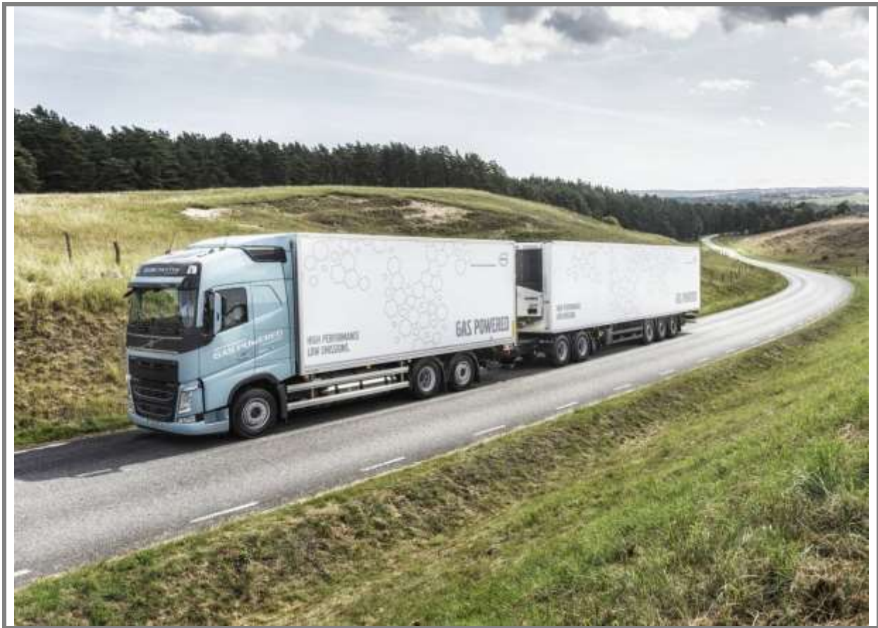
Рис. 2.81. Вантажний автомобіль Volvo FH LNG з газовим двигуном Volvo G13C
