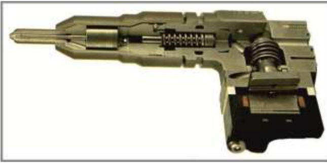
Рис. 2.61. Насос-форсунка з гідроприводом і електромагнітним керуванням
