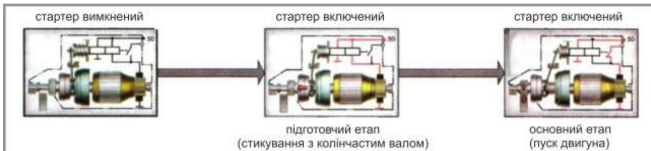
Рис. 2.99. Етапи режиму роботи стартера під час пуску двигуна
