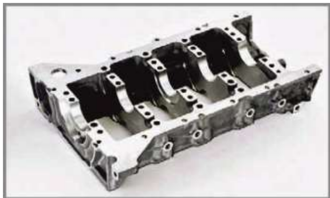
Рис. 2.26. Рама сходового типу в блоці, яка замінює звичні кришки корінних підшипників колінчастого вала в конструкції сучасних ДВЗ
