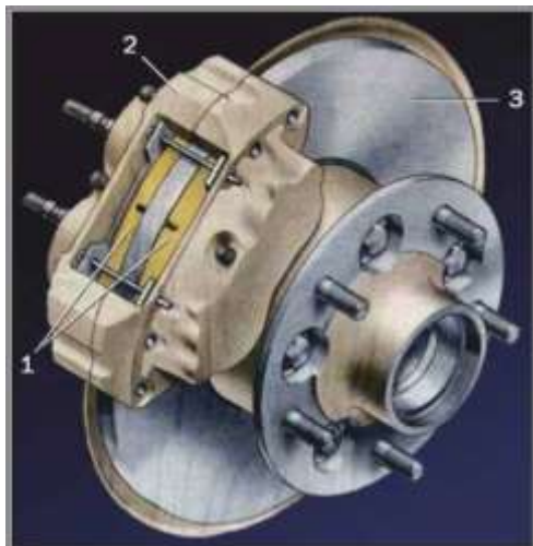
Рис. 4.10. Дисковий гальмівний механізм: 1 – колодки; 2 – супорт; 3 – диск
