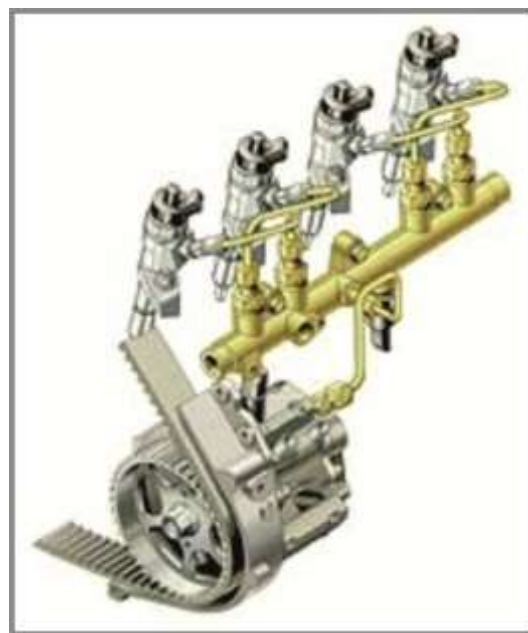
Рис. 2.66. Паливна система Common Rail на турбодизелі PSA HDI
