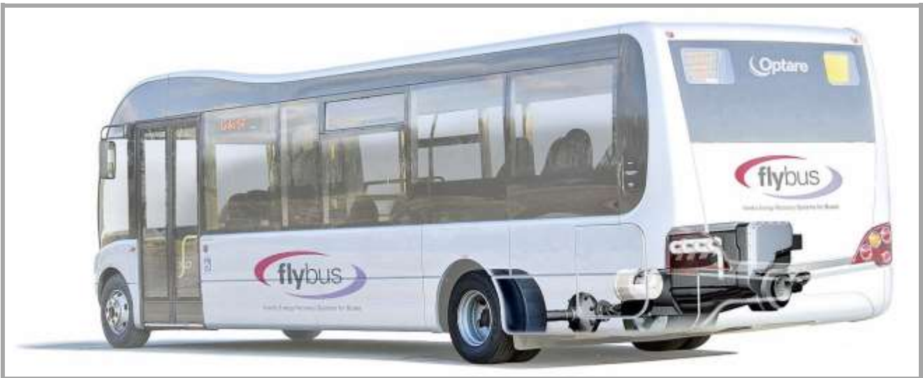
Рис. 8.5. Автобус Flybus, обладнаний допоміжним маховиком Ricardo
