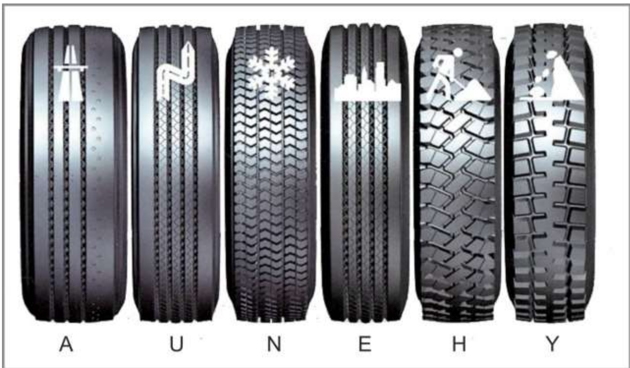
Рис. 5.24. Класифікація вантажних шин до умов експлуатування: A – магістральні перевезення; U – регіональні та магістральні перевезення; N – зимні шини; E – для міських шляхів та передмістя; H – для будівельної техніки; Y – для лісової місцевості
