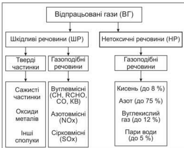
Рис. 2.89. Класифікація складу відпрацьованих газів дизеля: СН – неканцерогенні вуглеводні; RCHO – альдегіди; CO – оксид вуглецю; KB – канцерогенні вуглеводні; NOx – оксиди азоту; SOx – оксиди сірки
