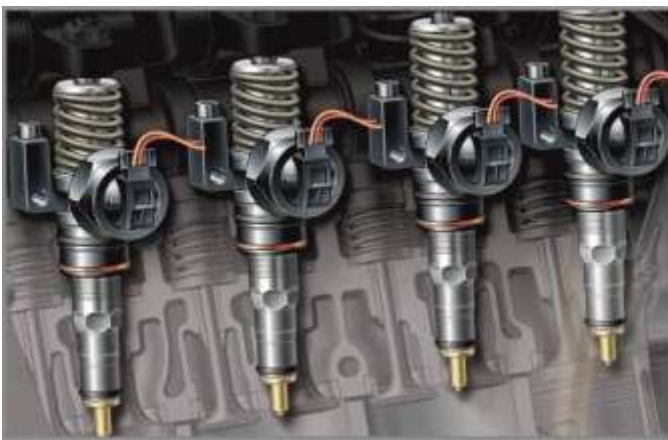
Рис. 2.53. Система впорскування палива в дизель насос-форсунками
