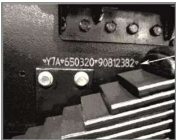
Рис. 1.8. Приклад розшифровки ідентифікаційного номера *Y7A*650320*90812382* (вантажний автомобіль КрАЗ-65032): Y7A – за міжнародними стандартами позначається код підприємства-виготовлювача; 65032 – модель транспортного засобу; 9 – позначення модельного року (9 – 2009 р.); 812382 – порядковий виробничий номер транспортного засобу
