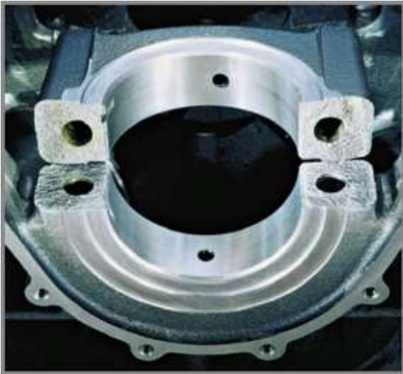
Рис. 2.15. Кришки корінних підшипників колінчастого вала двигуна виготовлені методом відламування
