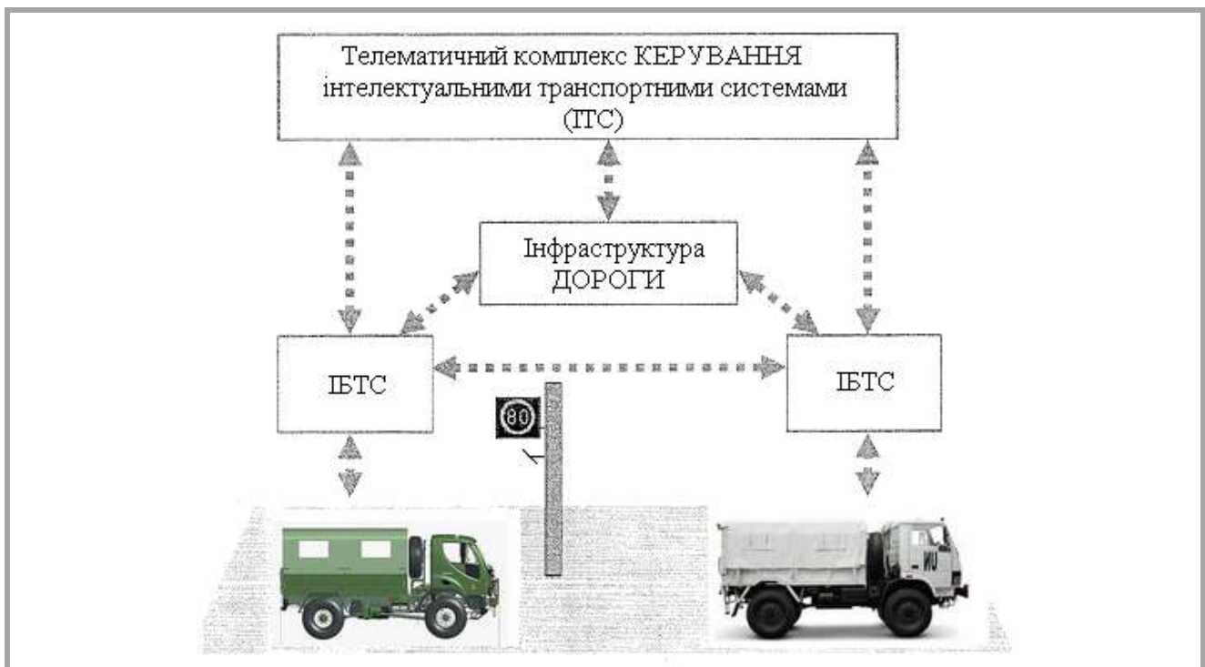
Рис. 7.30. Структурна схема телематичного комплексу керування ІТС
