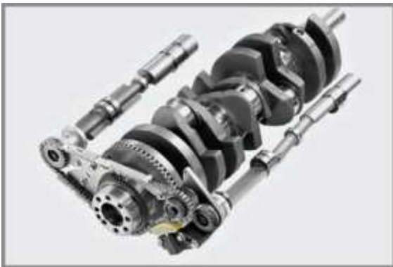
Рис. 2.20. Балансирні вали двигуна розташовуються поруч з колінчастим валом в блоці циліндрів і мають можливість обертатися в різні боки завдяки шестеренчатоланцюговому приводу
