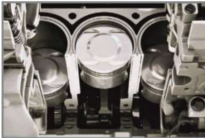
Рис. 2.25. Блок циліндрів двигуна з «сухою» гільзою. На розрізі добре видно, як вставлені в блок циліндрів «сухі» гільзи. Зверніть увагу на виконані в днищах поршнів поглиблення, що оберігають від торкання поршня клапанами
