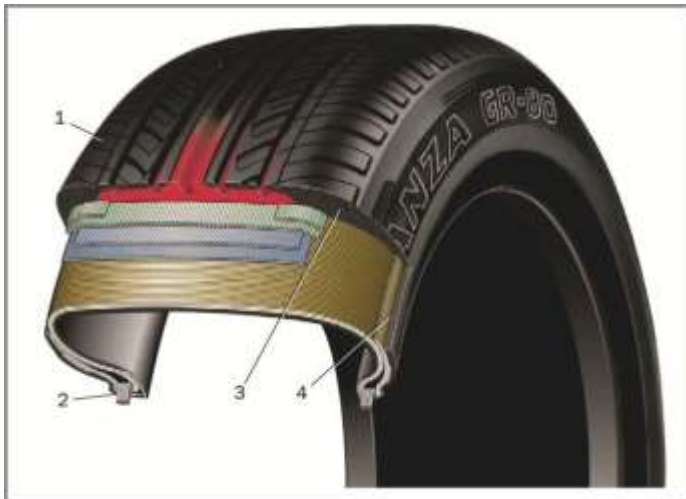
Рис. 5.21. Конструкція пневматичної шини: 1 – двошаровий протектор (червоним виділена м'яка гума); 2 – спеціальна форма бортового кільця; 3 – плечові частини, стійкі до порізів; 4 – захисний бортовий шар
