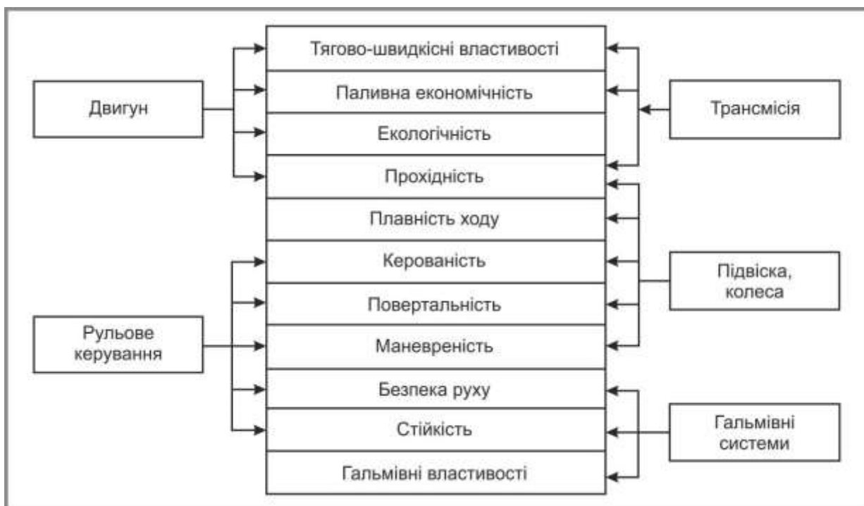
Рис. 7.12. Зв'язок експлуатаційних властивостей з системами і механізмами автомобіля
