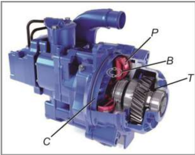
Рис. 4.24. Гідралічне гальмо-сповільнювач: С – статор; Р – ротор; В – циркуляція рідини; Т – трансмісія
