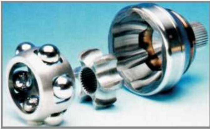
Рис. 3.31. Шестикульковий шарнір з ділильними канавками (шарнір «Бірфiльд»)
