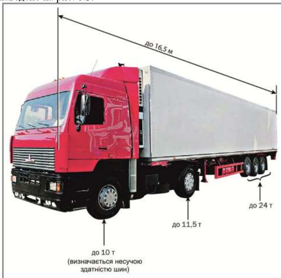
Рис. 1.3. Вагові та габаритні обмеження для п'ятивісного сидельного автопоїзда: габаритна ширина до 2,55 м (рефрижератори до 2,60 м); повна маса до 40 т; висота до 4 м; довжина до 16,5 м
