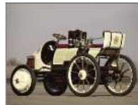
1900 р. – Фердинанд Порше виготовив перший електромобіль, поєднавши електропривод з бензиновим двигуном
