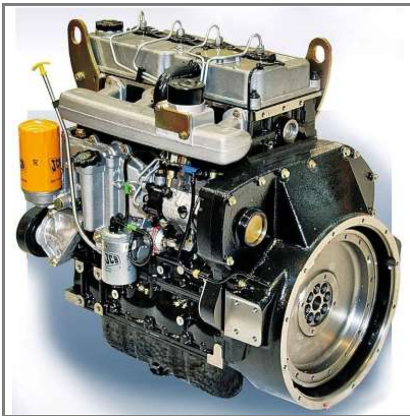
Рис. 2.85. Газодизельний двигун з системою управління британської компанії GSPK Multifuel Technology
