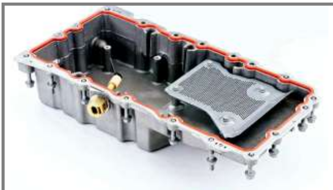
Рис. 2.31. В піддоні картера сучасного двигуна встановлено датчик рівня масла
