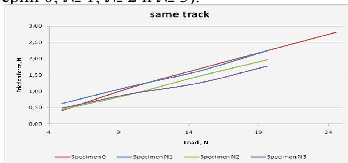
Рисунок 9 – Зависимость силы трения от нагрузки.
