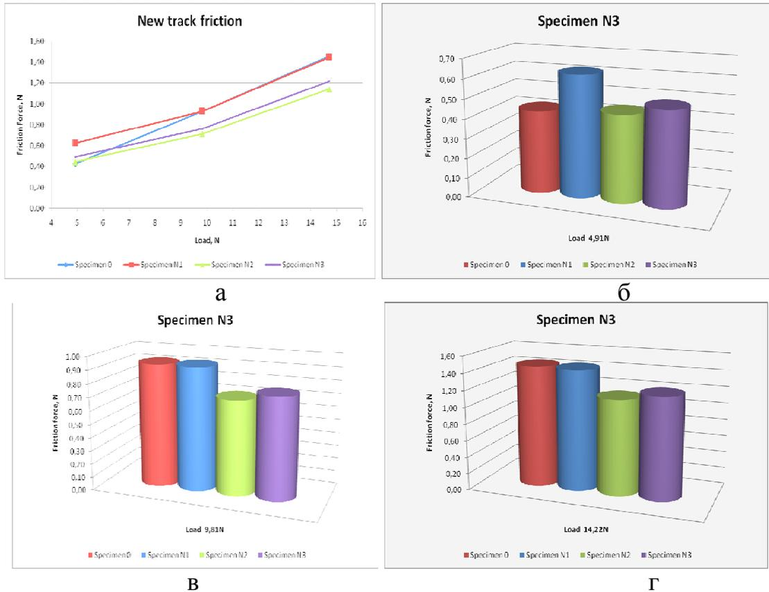
Рисунок 11 – Сводный график (а) и сравнительные диаграммы (б, в, г) изменения сил трения для всех серий образцов при нагрузках 4,91; 9,81 и 14,72 Н. Следует отметить, что в данном случае при изменении нагрузки изменяли контактирующие поверхности шарика и образца. Для данных пар трения в табл. 9 представлены средние силы трения F и коэффициенты трения  $\mu$ .
