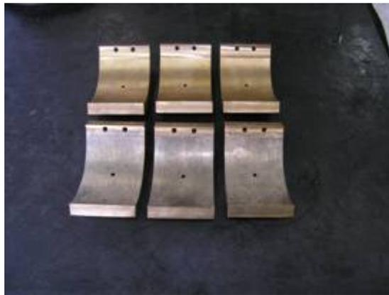
Рисунок 3 – Бронзовые вкладыши подшипников скольжения.
