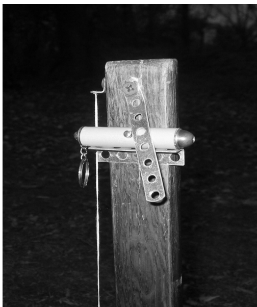
Рис. 1. Прибор для измерения ординат поверхности забоя
