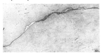
Рис. 3. Фосфидная эвтектика и горячая трещина на границе зерен основного металла; X 800
