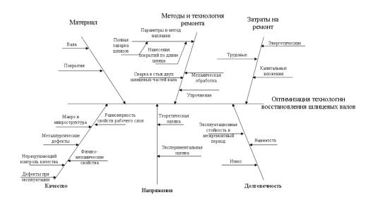
Рис.1 Диаграмма оптимизации технологии восстановления шлицевых валов
