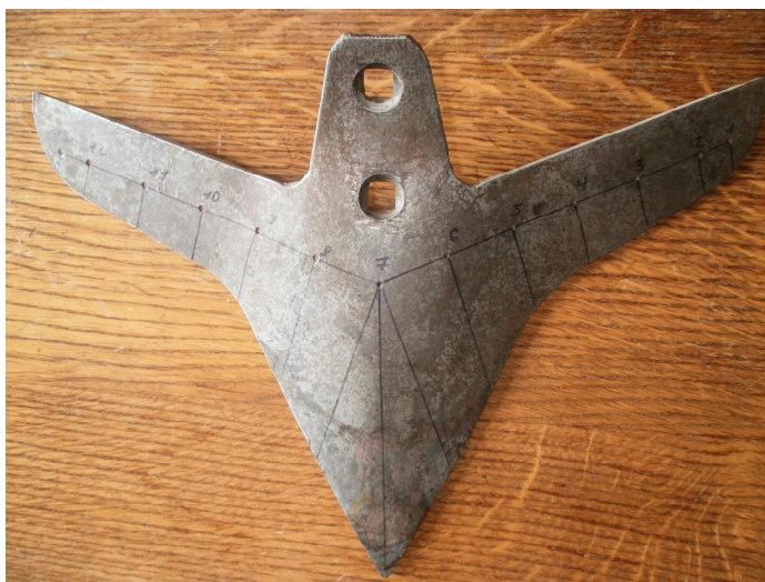
Рис. 1. Схема розташування контрольних точок на досліджуваній лапі
