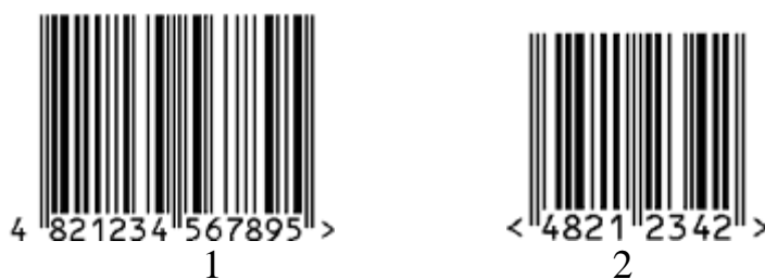
Рисунок 3.4 – Приклад символіки EAN/UPC: 1 – штрихкодознакка EAN-13; 2 – штрихкодознакка EAN-8
