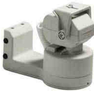
Рисунок 5.16– Двоплощинний поворотний пристрій (сканер) IPT-720 Videotec (Італія)
