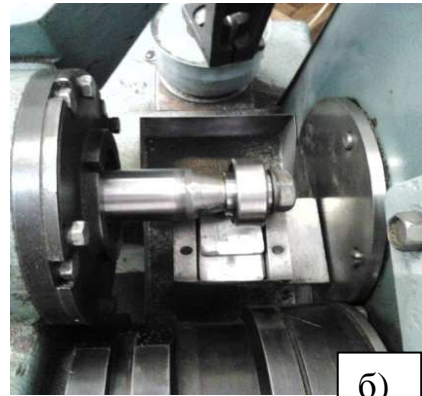
Рис.5. Реалізація процесу відновлення підшипника кочення в лабораторних умовах: а) загальний вигляд устаткування; б) укрупнений вигляд установки підшипника під час відновлення.
