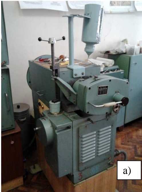
Рис.5. Реалізація процесу відновлення підшипника кочення в лабораторних умовах: а) загальний вигляд устаткування; б) укрупнений вигляд установки підшипника під час відновлення.
