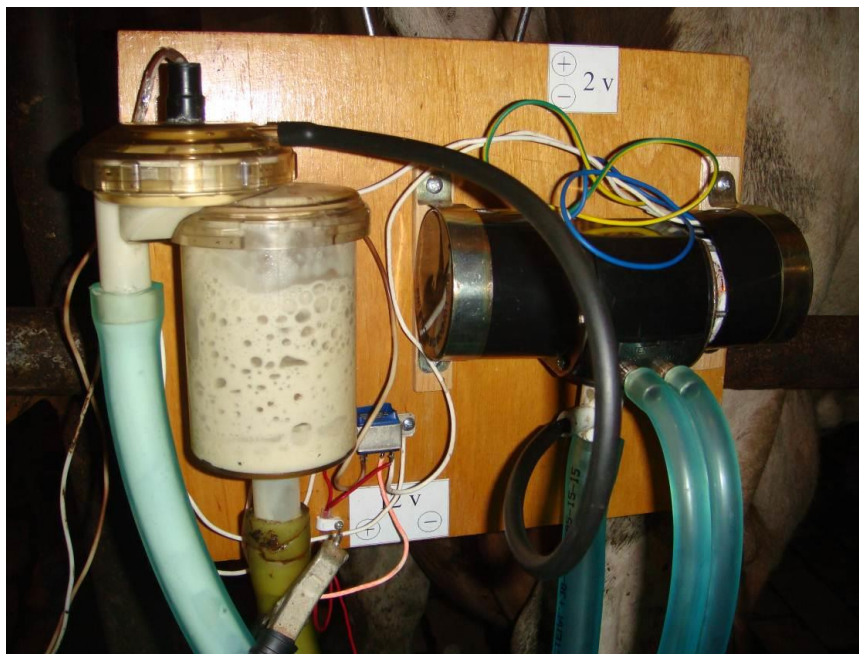
Рис. 2 – Экспериментальный доильный аппарат подключенный к контуру доильной установки АДМ-8
