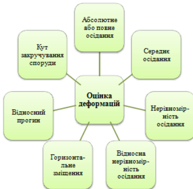
Рисунк 1 – Параметри оцінки деформацій споруд
