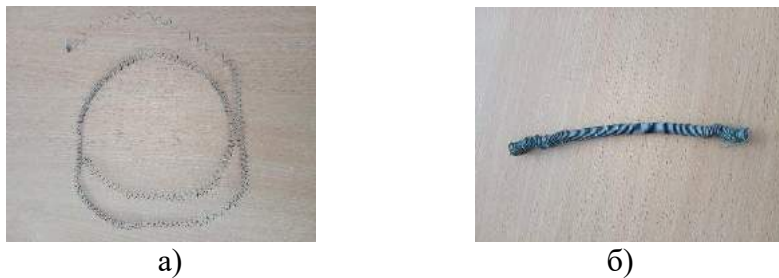
Рисунок 1 – Термообробка елемента з ефектом пам'яті форми на основі Ni–Ti а) – сплав після термообробки в розтягнутому вигляді; б) вигляд сплаву після занурення в теплу воду;
