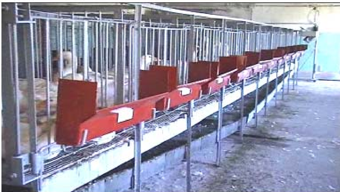
Рис. 2. Кліткова батарея для вирощування і утримання водоплавної птиці
