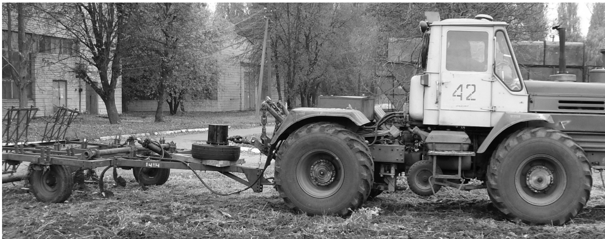
Рис.6. Машинно-тракторний агрегат у складі трактора Т-150К та культиватора КПЕ-3,8, який обладнано механічним накопичувачем енергії.
