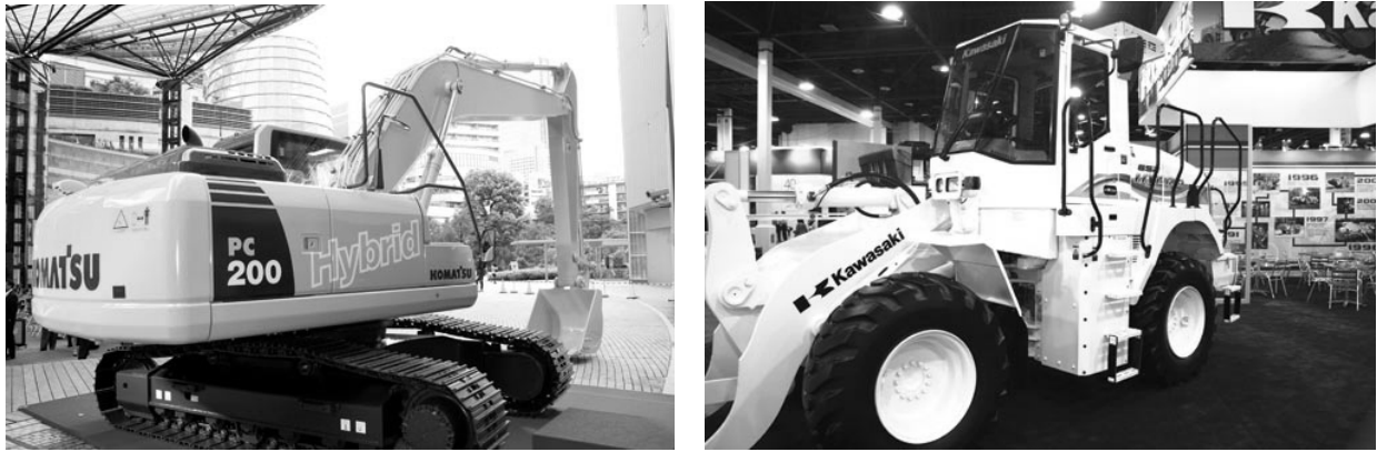
Рис.1. Дорожньо-будівельна техніка фірм Komatsu та Kawasaki, яку обладнано накопичувачами енергії
