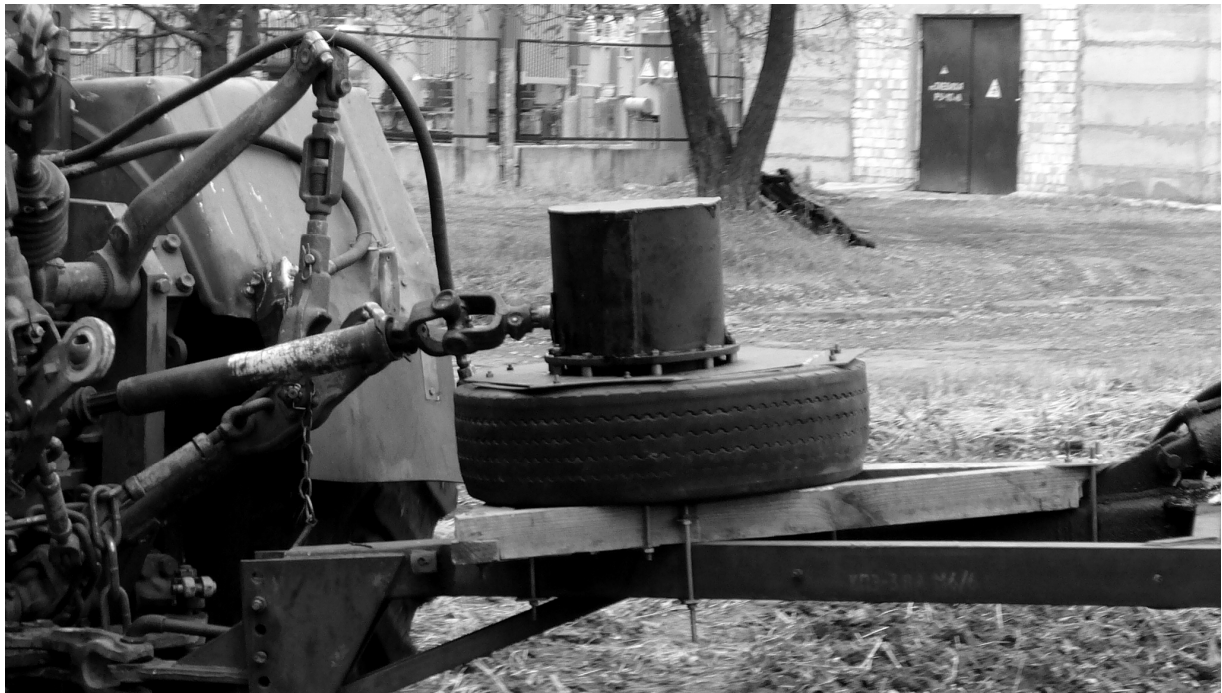
Рис.5. З'єднання механічного накопичувача енергії з валом відбору потужності трактора Т-150К.
