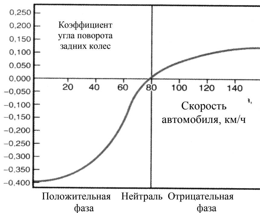
Рис. 2. Функциональная зависимость коэффициента поворота задних колес в зависимости от скорости автомобиля и угла поворота, заданного рулевым колесом.
