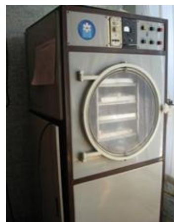
Рис. 3.2 - Вакуумна сублімаційна сушарка, яка є в серійному виробництві
