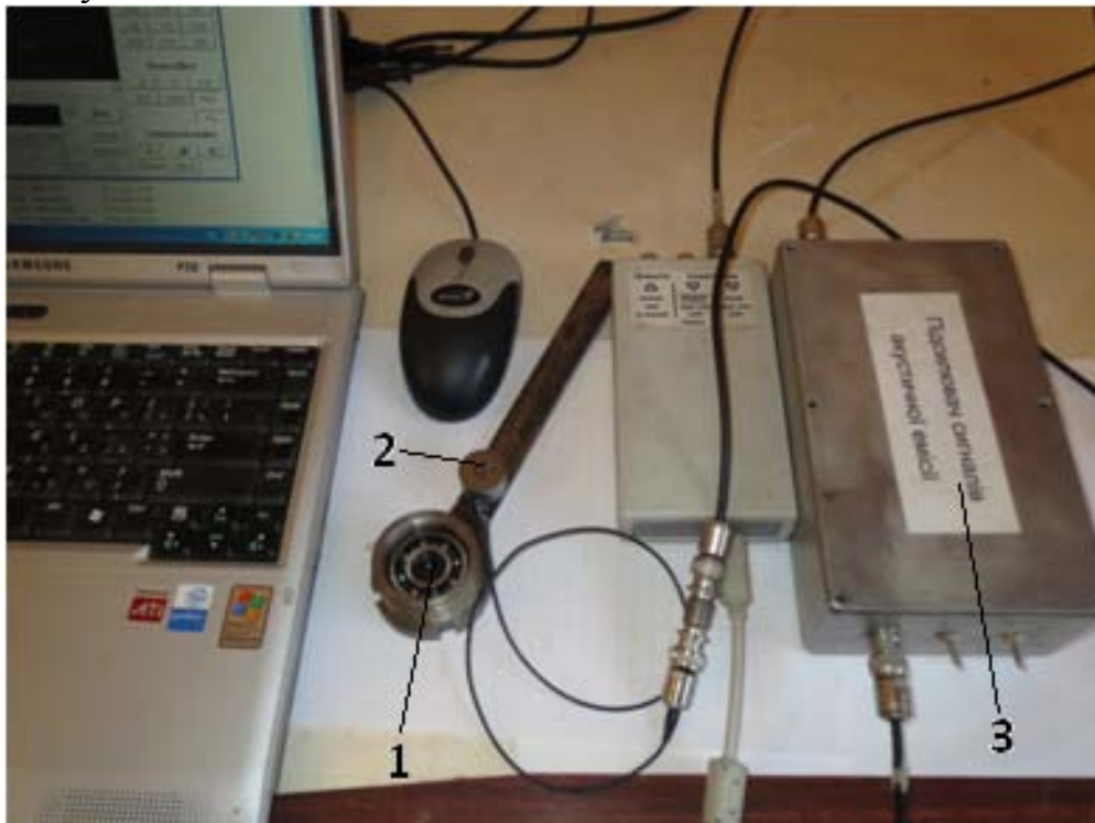
Рисунок 1 – Внешний вид устройства для исследования противопиттинговых свойств масел:
