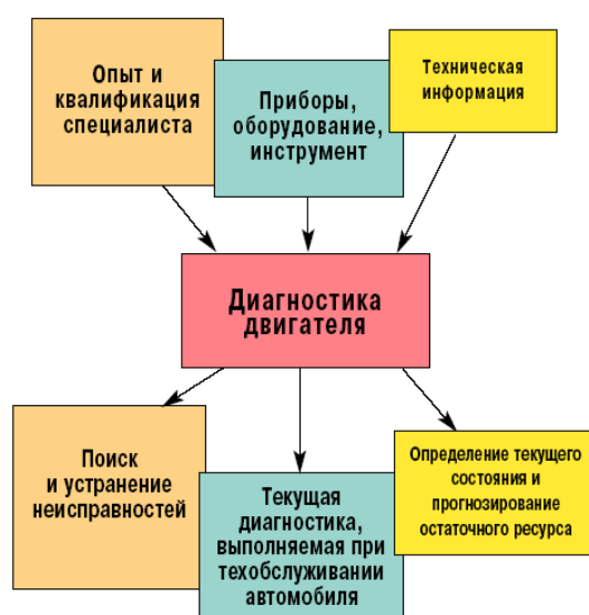
Рис. 6. Методика проведения диагностики автотракторных ДВС
