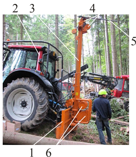
Рис. 1. Мобільна канатна установка фірми STEYR: 1-рама; 2-привідний трактор; 3-щогла; 4-направляючі блоки; 5-несучий канат; 6-привідні барабани (за матеріалами міжнародної виставки „Austroforma 2011“, м. Грац, Австрія, фото автора).
