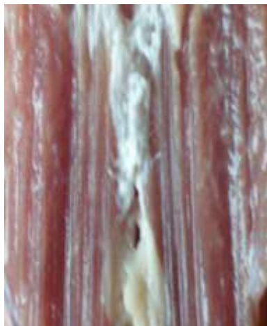
Рваний розріз \Delta P=100\text{МПа} ; V_n=10^{-1}\text{ м/с} ; t=-7^\circ\text{C}
