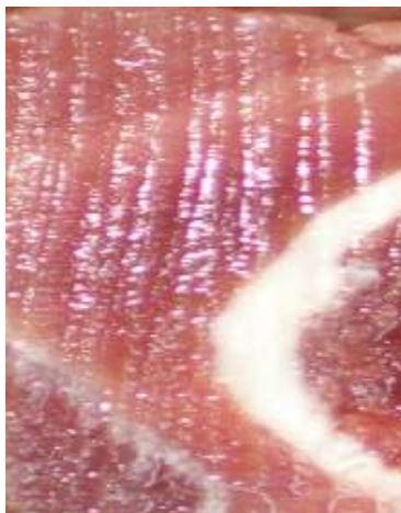
Рівний якісний розріз \Delta P=100\text{МПа} ; V_n=25\cdot 10^{-3}\text{ м/с} ; t=-25^\circ\text{C}
