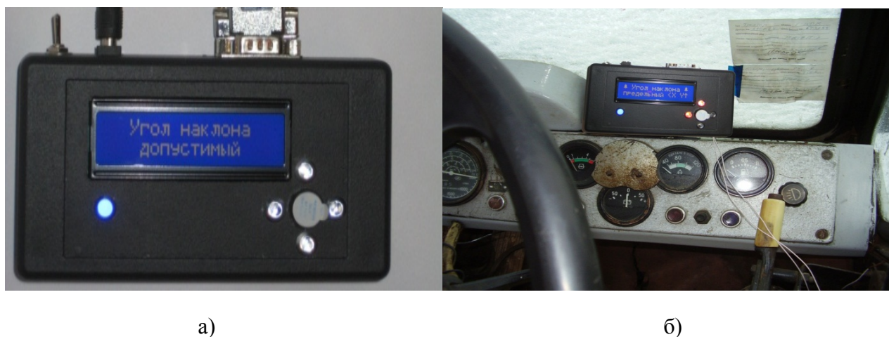
Рис. 2 – Система контроля предельных углов наклона мобильной машины: а) общий вид прибора ПЗФ-2К; б) эксплуатационные испытания системы контроля
