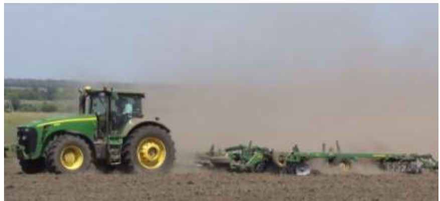
Рис. 20. Проведення динамічних випробувань МСА у складі трактора John Deere-8430 та дискової борони John Deere-637
