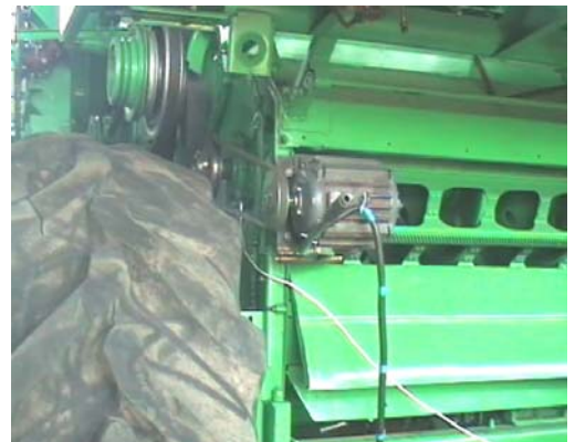
Рис. 15. Вимірювання віброшвидкості молотильного барабана комбайна «Дон 1500» за допомогою розробленого приладу
