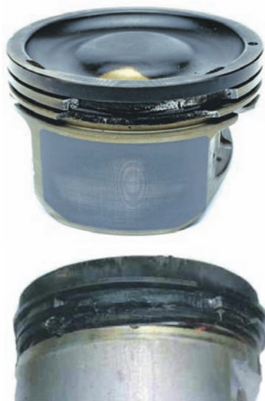
Разрушенные перемычки поршневых колец по причине неполадок в процессе сжигания топлива
