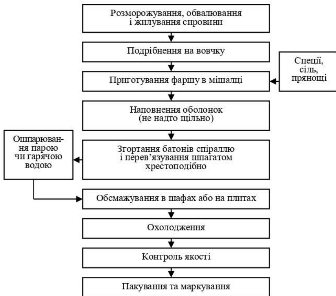
Рис. 1.5. Принципова технологічна схема виробництва ковбаси смаженої «Українська» вищого сорту
