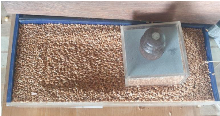
Рис. 1.33. Утворення ущільненої, орієнтованої структури в процесі зсуву
