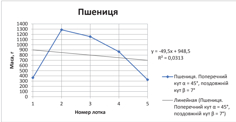
Рис. 5.30 Розподіл по масі у приймальних ємностях після сепарації. Поперечний кут \alpha=45^\circ , позовжній кут \beta=7^\circ
