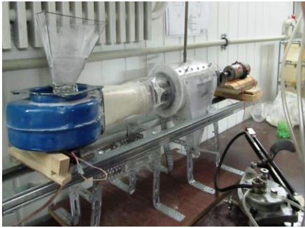
1 – корпус; 2 – опори; 3 – вал; 4 – завихрювач; 5 – доочисник; 6 – двигун; 7 – жалюзі; 8 – камера осаджувальна; 9 – затвор шлюзовий; 10 – вентилятор; 11 – діафрагма; 12 – пілодозатор; 13 – мікроманометр ММН - 240(5)-1,0; 14 – мікроманометр водяний; 15 – анемометр чашковий; 16 – анемометр testo 416 Рисунок 8 – Лабораторна установка для досліджень розробленого РЦ
