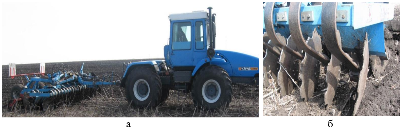
Рисунок 6 – Загальний вигляд (а) і робочі органи експериментального зразка (б) дискатора ДЛ-5 із трактором ХТЗ-17022
