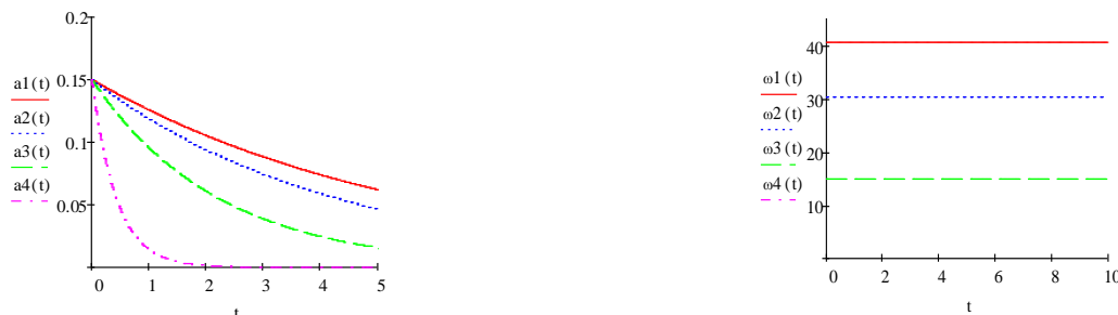
Рисунок 4 – Закономірності зміни амплітудно-частотної характеристики системи «телескопічний гвинт – сипке середовище» за різних кількостей руху останнього та змінної довжини гвинта при \rho_1 = 15 \text{ кг/м} ; l = 6 + 0.2t ; V = 5 \text{ м/с} ; I = 6 \cdot 10^{-6} \text{ кг/м}^2 ; E = 2,06 \cdot 10^{11} \text{ Н/м}^2 ; \rho_2 = 30 \text{ кг/м}
