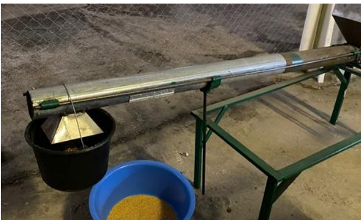
Рисунок 22 - Загальний вигляд процесу сепарування телескопічним гвинтовим транспортером-сепаратором
