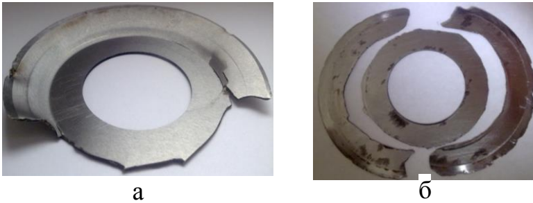
Рис.3. Втомне руйнування основної частини ножів, втрата планшетності (а - зміна форми) і його руйнування (б - на окремі кільцеві складові)
