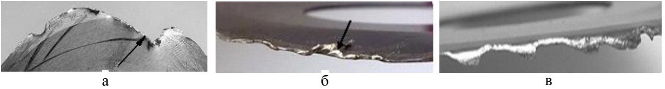
Рис. 2. Вирид металу (а), згин (б), пластичне деформування (в) леза ножа
