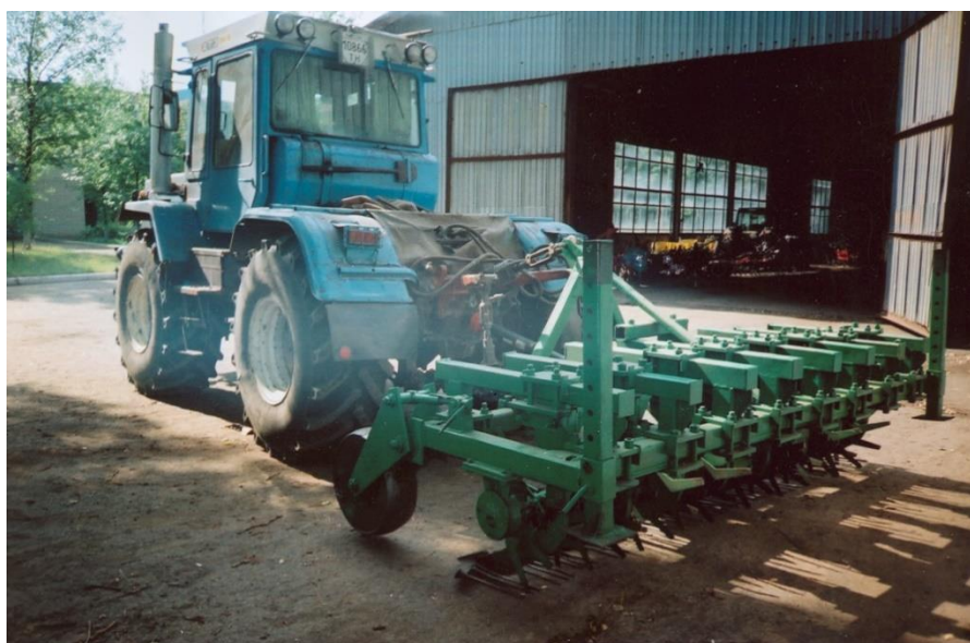
Рис.3. Загальний вигляд експериментальної польової роторної розрихлювально-сепаруючої установки
