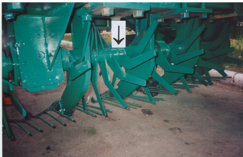
Рис.6. Ротор експериментальної ґрунтообробної машини
