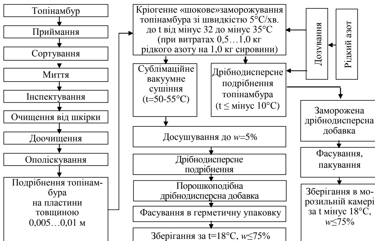
Рис. 5. Технологічна схема виробництва заморожених та порошкоподібних дрібнодисперсних добавок із інуліновмісної сировини (топінамбура)
