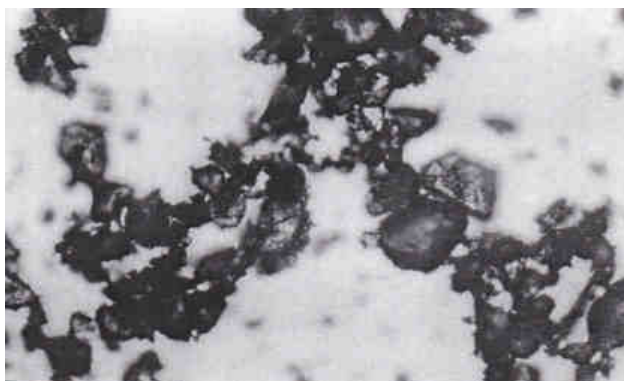
Рис. 6. Знімок поверхні зразка \alpha -інуліну (1×250)
