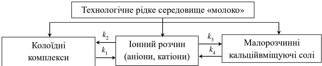
Рис. 1. Схема можливих перетворень TRC_m у технологічному потоці ( k_1, k_2, k_3, k_4 – кінетичні коефіцієнти, які характеризують: k_1, k_2 – процеси перетворень колоїдних комплексів у істинний іонний розчин та іонів з істинного розчину в колоїдні комплекси відповідно; k_3, k_4 – процеси переходу іонів з істинного розчину в малорозчинні солі та малорозчинних солей у істинний іонний розчин відповідно)
