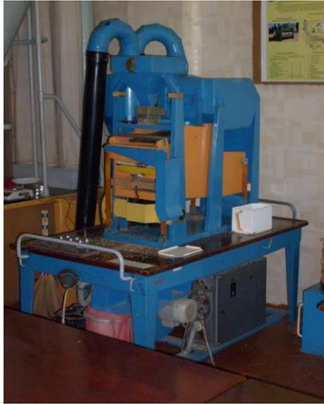
Рис.2. Общий вид вибрационного сепаратора
