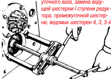
Рис. 16. Выпрессовка подшипника № 60210, замена гнезда подшипника промежуточного вала.
