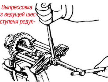
Рис. 13. Снятие переднего гнезда втулки ренного вала, замена на шлицевой втулки.
