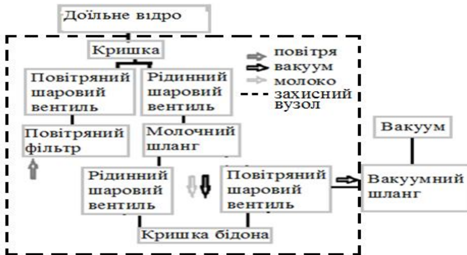
Рисунок 2 – Блок-схема захисного вузла для перекачування молока при удосконаленні процесу його транспортування
