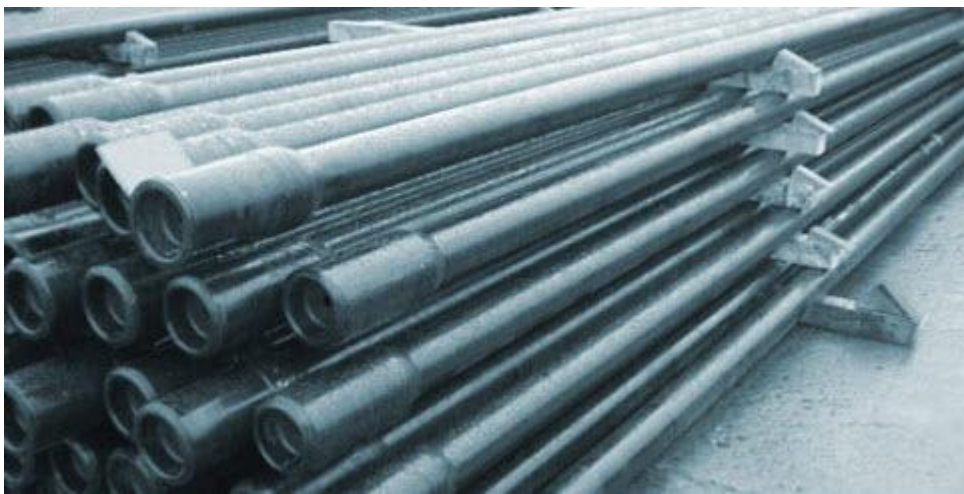
Рисунок 2 - Складское хранение НКТ на открытой площадке производственной базы
