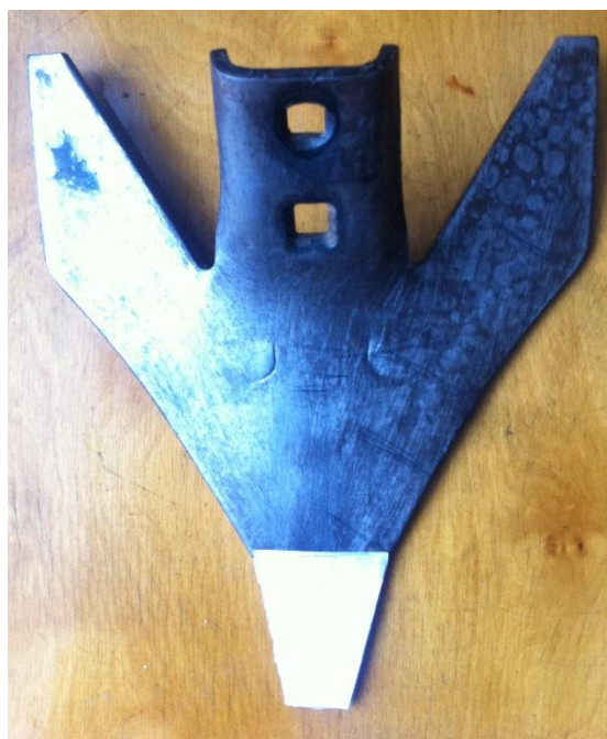
Рисунок 14 - Схема приварки носка к культиваторной лапе
