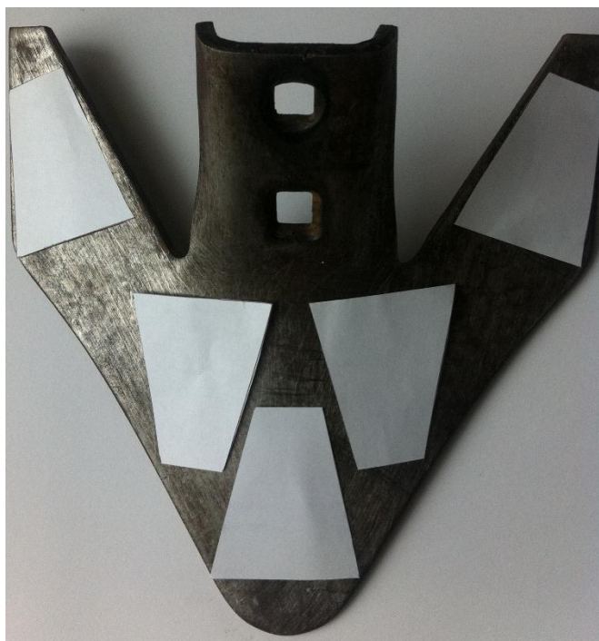
Рисунок 12- Раскрой изношенной лапы для вырезки заготовок
