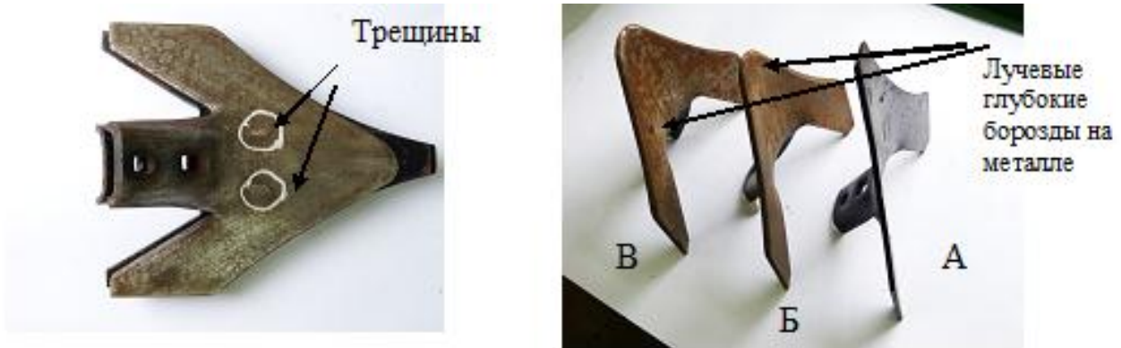
Рисунок 4 - Выявленные дефекты лапы культиватора типа МАРАФОН (MARATHON/DELTA BUSTER SWEEPS).
