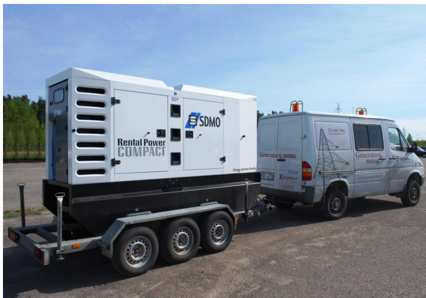
Рисунок 1 – Приклад дизель-генераторної установки SDMO в контейнері на причепі
