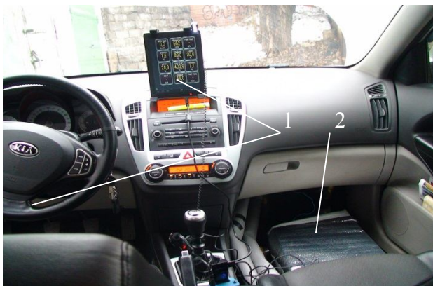
Рисунок 2. Бортовий інформаційний програмно-діагностичний комплекс (1), розташований на ТЗ, оснащеного СКП (2), що працює в межах віртуального підприємства з експлуатації автомобільного транспорту
