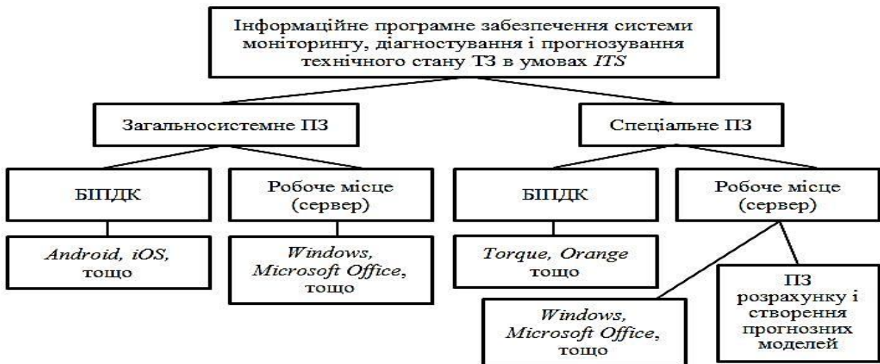
Рисунок 7. Структура інформаційного забезпечення системи моніторингу, діагностування і прогнозування технічного стану ТЗ в умовах ITS
