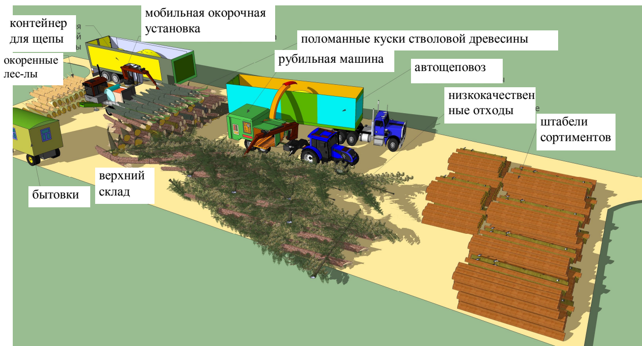
Рисунок 1. Производство технологической и топливной щепы на верхнем складе
