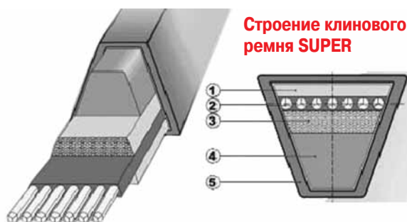
Рис. 1. 1 - резиновая накладка, 2 - тяговая ветвь из корда, 3 - резиновый стержень, усиленный текстильными волокнами, 4 - высокопрочный каучук, 5 - усиленная оплетка
