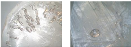
а б Рисунок 1 – Пористість драгль альгінату кальцію, утворених на основі CaCO 3 (а) та Ca 3 (PO 4 ) 2 (б)
