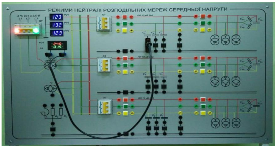
Рисунок 4.1 – Загальний вигляд лабораторного стенда квазіфізичної моделі розподільної електричної мережі
