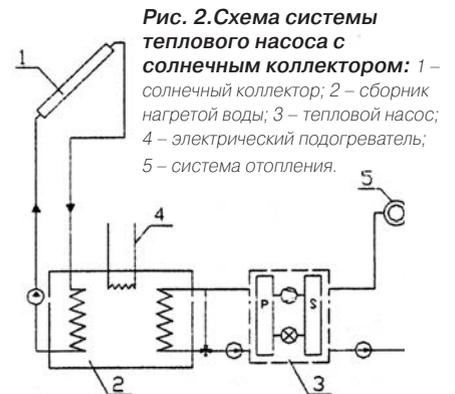
Рис. 2. Схема системы теплового насоса с
