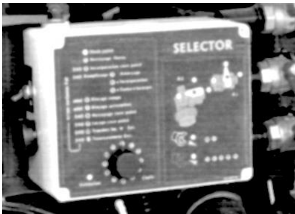
Рис. 73. Пульти діагностики і баки змішувачів причіпного обприскувача Olympia 320 S (ВОМ для насоса ГС) і самохідного Nimpheos 3240 від Caruelle-Nicolas
