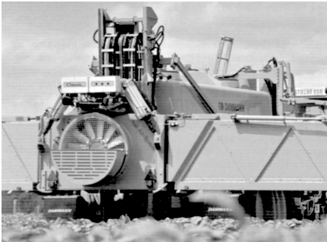
Рис. 77. Зовнішній вигляд Dual-Air-системи і його вентилятора на штангах обприскувачів Dammann «Подвійний удар» за один прохід
