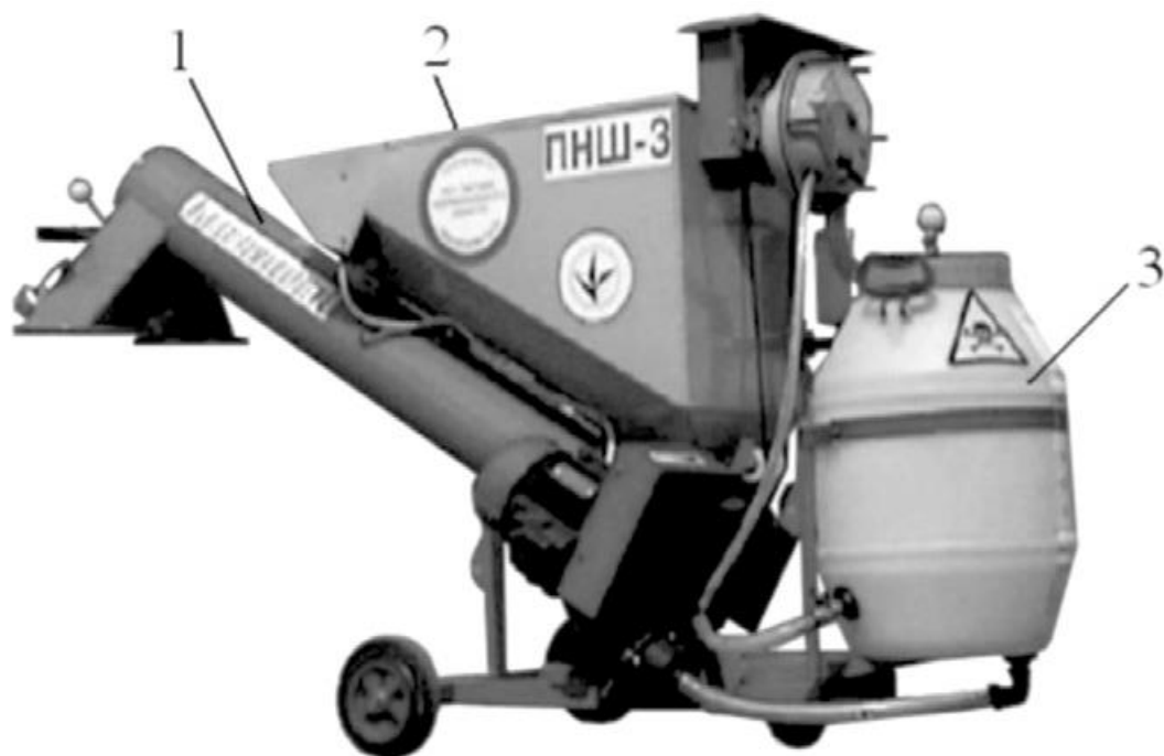
Рис. 44. Протруювач ПНШ-3 «Фермер»: 1 – шнек; 2 – бункер; 3 – бак
