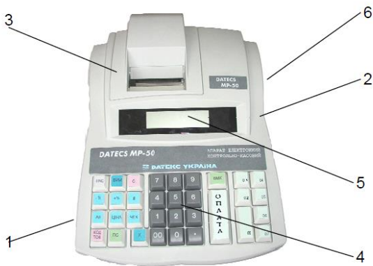
Рисунок 1 – Склад апарата «DATECS MP-50»: 1 – основа; 2 – верхня кришка корпусу; 3 – кришка принтера; 4 – клавіатура; 5 – індикатор оператора; 6 – вбудований акумулятор
