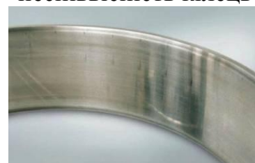
пошкодження при складанні
