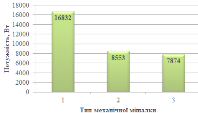
Рис.1 – Витрата потужності для електропривода механічної мішалки: 1 – шестилопатева, лопаті під кутом 90^0 ; 2 – якірна та рамна; 3 – лопатева двоярусна, по дві лопаті на ярус під кутом 90^0
