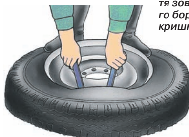
Рис. 6. Зняття внутрішнього борту покришки
