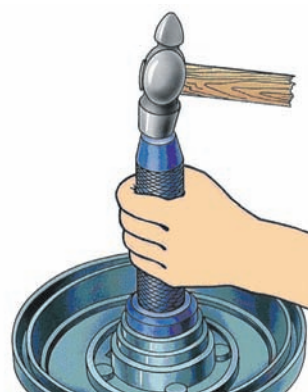
Рис. 4. Запресовка манжети і зовнішнього кільця підшипників маточини
